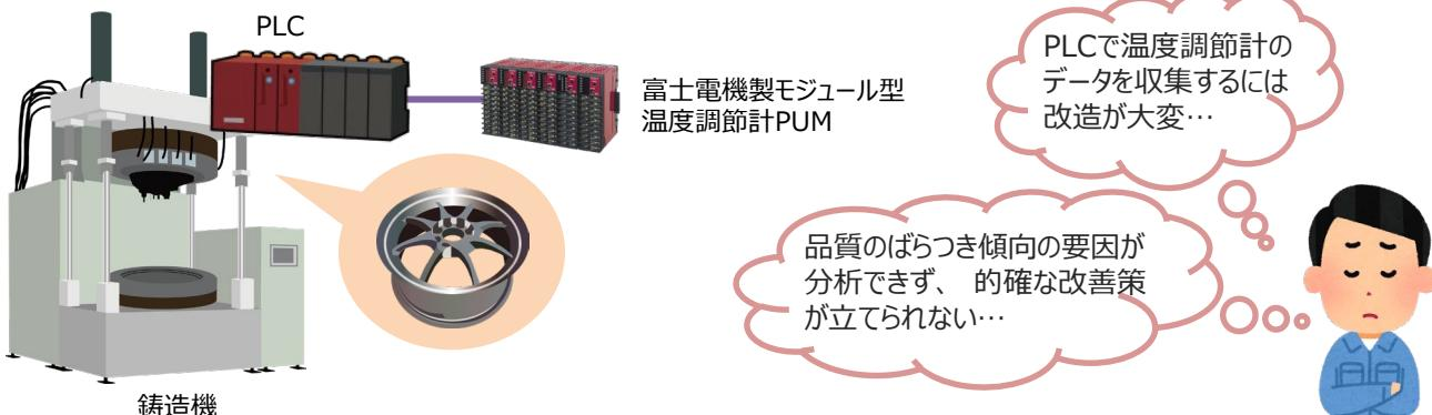
モニタッチと温度調節計で製造データを収集！
