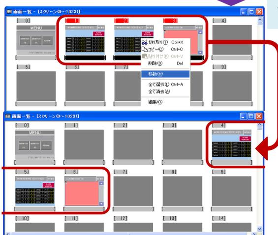
[機能：スクリーン] スイッチの切替先スクリーン No. が自動で変更されます。
