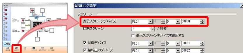
読込エリアn+2(スクリーンNo. 指令)と書込エリアn+2(表示スクリーンNo. )を統合して、『表示スクリーンデバイス』にしました。
