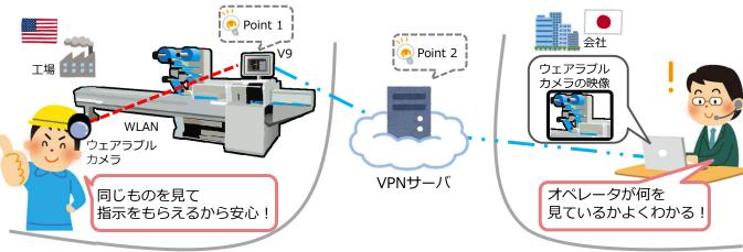
Web Machine Interface(VPN機能)サービスの活用で安心・安全・安価に現場へのリモートアクセスを実現できます!
