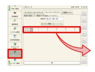
ローカル画面>I/Oチェック>ネットワークテスト 「設定IP]に確認したい機器のIPアドレスを入力して「テスト開始]を押します。
