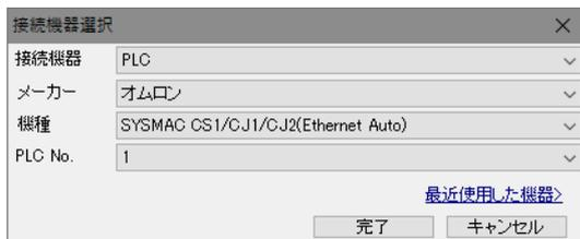
② [PLC1 プロパティ] の [通信設定] で、V9 のポート No. 9600 を設定します。
