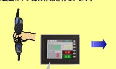
カウント表示でネジ締め完了 ごとにカウントアップ。
