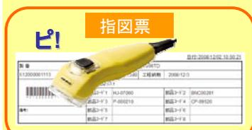
②準備された組立部品の2次元コードを読み込み部品情報を取得する。
