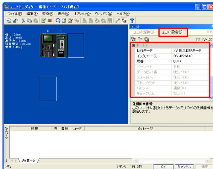
※ シリアルコミュニケーションユニット:KV-L20R/KV-L20Vをご利用の場合には、動作モード:KV BUILDER/KV STUDIOモードを選択します。その他の設定は、KV-L20と同じです。
